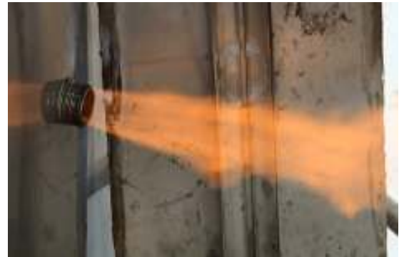
fig.36 ペレットのガス化
